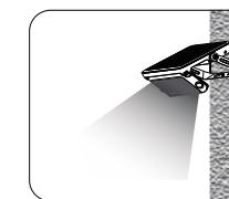
**IT** - Possibilità di fissaggio a muro o a palo tramite la staffa in dotazione. Adatto sia per pali tondi (Ø40-60 mm) che quadrati (L 30-40 mm).
