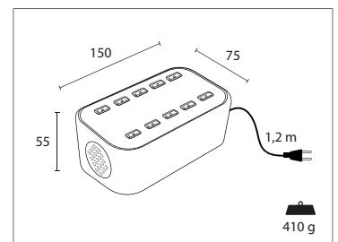
**IT** - Stazione di ricarica USB, adatto alla ricarica simultanea di qualsiasi dispositivo dotato di ricarica USB standard. Ventola di raffreddamento integrata per la corretta dissipazione del calore e la prevenzione di danneggiamenti dovuti a surriscaldamenti.
