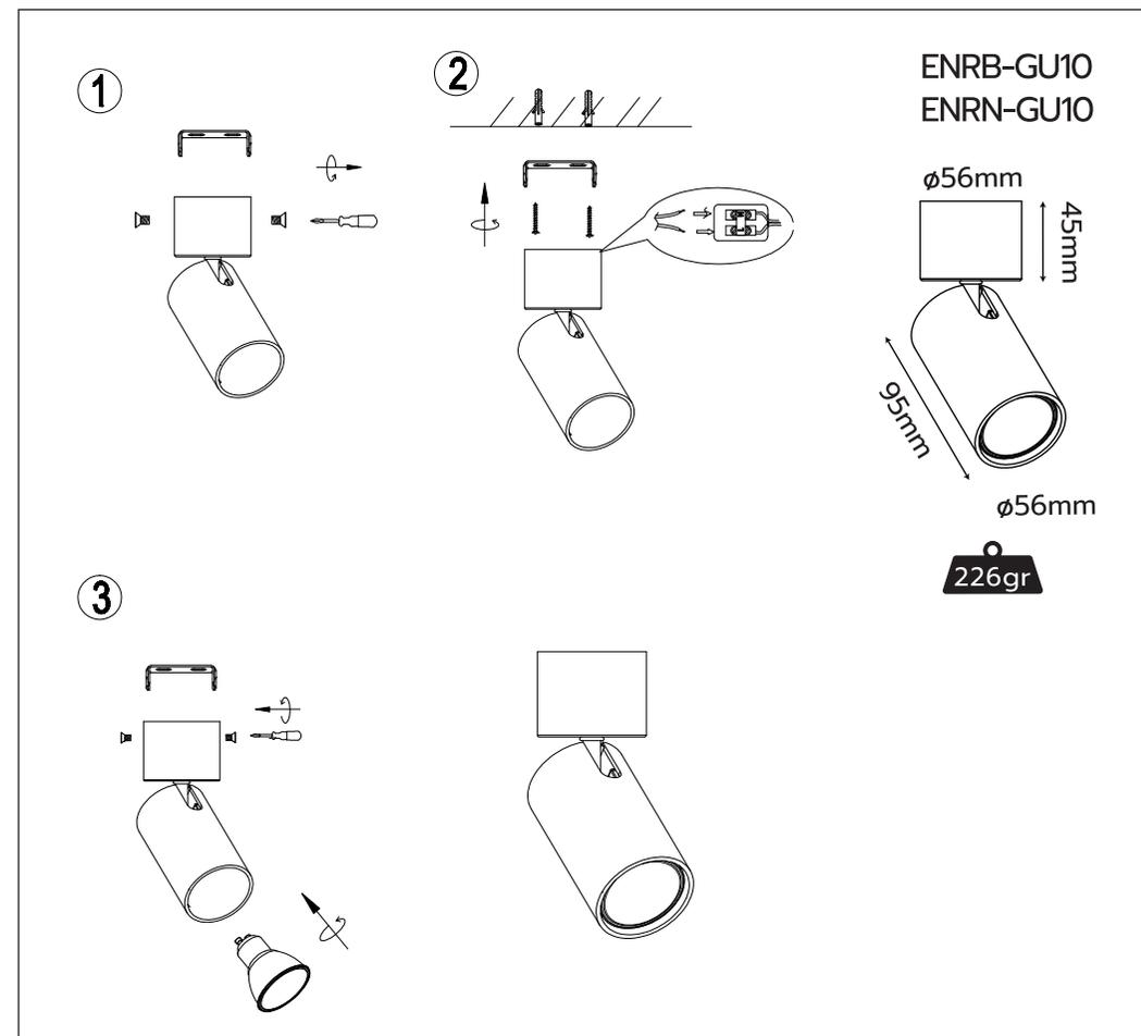
**IT** 1. Svitare la staffa dal supporto a plafone e fissarla al soffitto con le viti e i fermi in dotazione - 2. Eseguire il collegamento elettrico - 3. Rimontare il supporto a plafone alla staffa, montare la lampadina GU10 (LED) (per i modelli a sospensione occorre sfilare il meccanismo a scatto).
